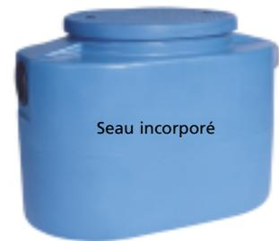
Le **séparateur à graisses** (ci-dessus) est à prévoir si la fosse septique est placée à plus de 10 mètres de la maison et doit être implanté à moins de 2 m. de l'habitation. Son installation suit les conseils et recommandations décrits ci-dessous. Les eaux vannes (WC, douche, lavabo, machine à laver) ne doivent jamais passer par le séparateur à graisses.
