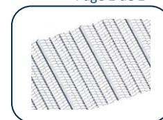
Des fixations en acier doivent être posées à intervalles réguliers pour maintenir le treillis fermement en position. Le lattis doit également être correctement enrobé dans le béton.
