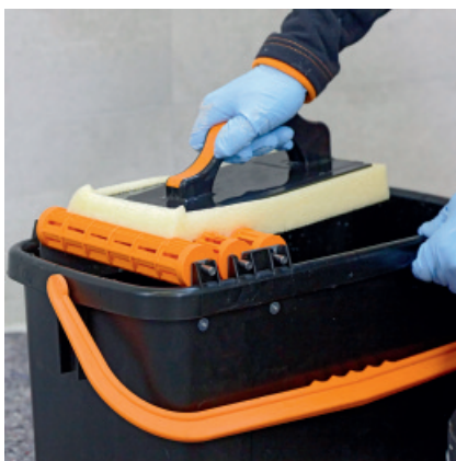
Il est important de renouveler fréquemment l'eau de lavage (tous les 5 à 10 m 2 ).
