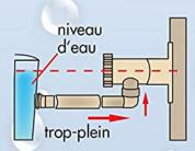
5. Placer le coude sur le robinet. Fixer l'embout à la cuve. Relier l'embout au coude avec le tuyau.
