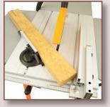
Guide transversal et à onglet réglable jusqu'à 60°
